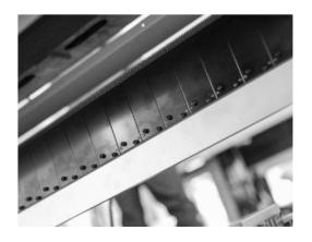
可拆卸多片式梳子无废纱起底结构,节省废纱 并且便于更换
