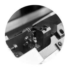
剪刀夹子机构通过系统控制自动夹纱、 放纱、剪断纱线
