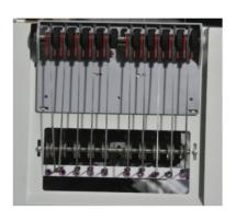
配备张力可调节式侧天线组件,1-6档位根据编织 需求调节,更精确满足张力需求
