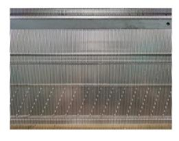
配置高精度的铣式针板和插片式针板,两种 均可选配,满足不同需求
