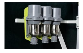
选配优质储纱装置,纱线张力控制更加均匀,断纱报 警更加灵敏
